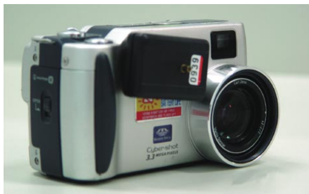
FIGURA 2 - Fotocélula fixada à câmera com fita dupla face.
