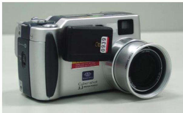
FIGURA 4 - Adaptador tubular conectado à câmera.
