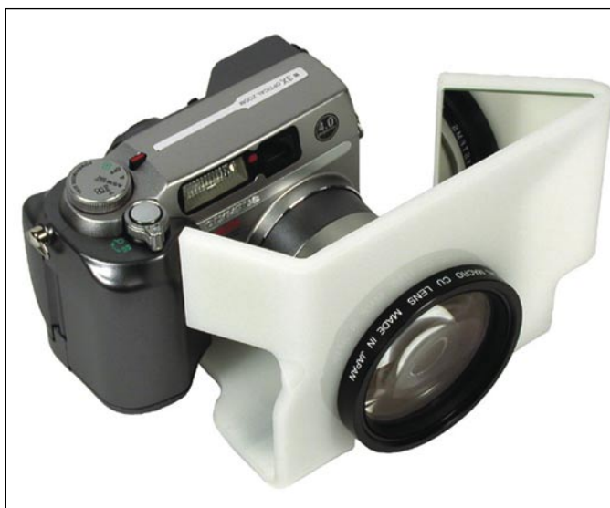
FIGURA 8 - Câmera digital adaptada com difusor e lente close up.
