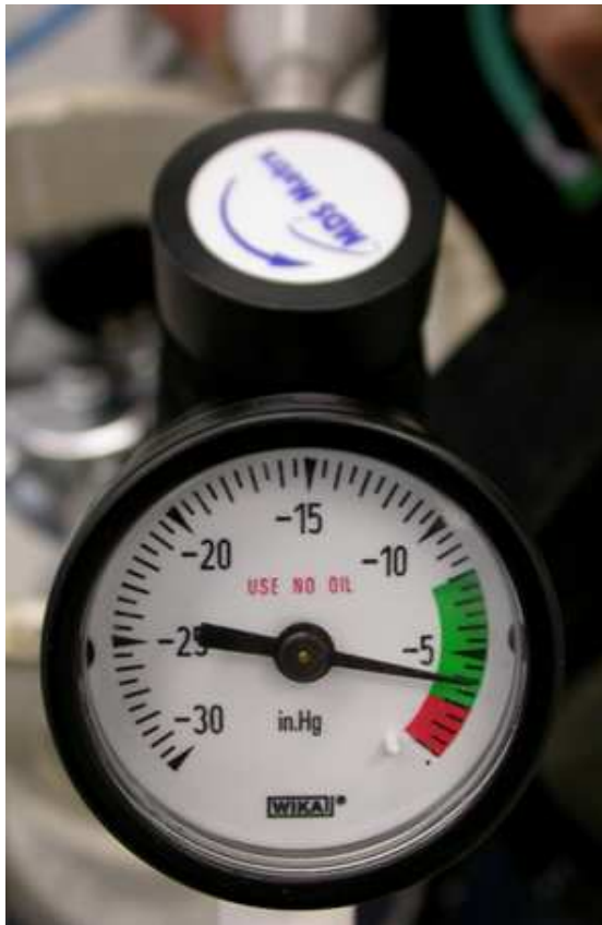
Foto4 - Modelo de controlador de vácuo, Vacuômetro
